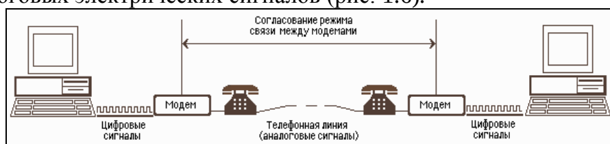
Рис. 1.6. Схема работы dial-up соединения
